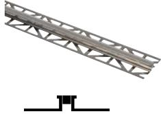
Visoko opteretivi metalni profil (nehrđajući čelik ili aluminij) s ekspanzijskim materijalom od silikona. Za formiranje visoko mehaničko opterećenih dilatacijskih spojeva za keramičke obloge ili kamen u zatvorenom ili otvorenom prostoru. Sprječava pukotine i oštećenja koja mogu nastati zbog povećane napetosti tijekom faze izgradnje. Nadalje, ovaj profil smanjuje širenje strukturnog i udarnog zvuka.
