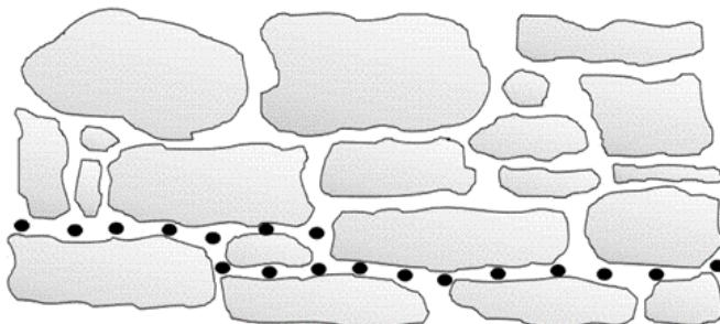
Nakon potpune impregnacije zida, bušotine moraju ostati otvorene 30 - 60 dana, kako bi se odvijale sve kemijske reakcije s CO<sub>2</sub> iz zraka. Nakon završenog procesa silikonizacije rupe se pune HYDROSTOP PENETRAT-om ili cementnom suspenzijom.
